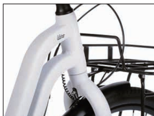
Stark mit Schwung: Die Rahmenrohre bringen viel Stabilität.
